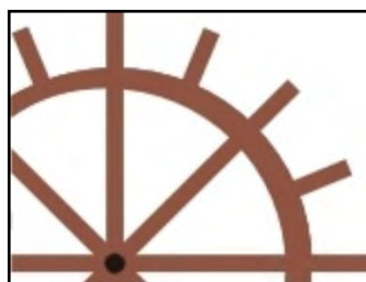
Abb. 38: Schaufelräder sind die einfachsten, aber vom Wirkungsgrad her die schlechtesten Wasserräder. Sie besitzen radial angeordnete Bleche oder Bretter (Schaufeln), die von allen Seiten offen sind. Um den Wirkungsgrad zu steigern, laufen die meisten Schaufelräder in einem Kropfgerinne.
